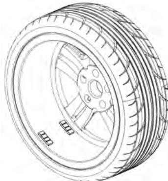
Los dos pesos adhesivos tendrán que aplicarse de manera estable para poder efectuar dos mediciones mediante el calibre automático de distancia y diámetro y dos posicionamientos del láser Spotter mediante las teclas en el monitor.
