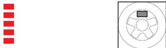
Si está habilitada "OPPOSITE POSITION", en la pantalla de fase se indica también la posible posición de aplicación del peso abajo (a las 6) para facilitar la limpieza de la llanta y la correspondiente aplicación de pesos adhesivos. El símbolo utilizado es:
